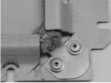
Figure 15: Les clips de l'encadrement du verre
