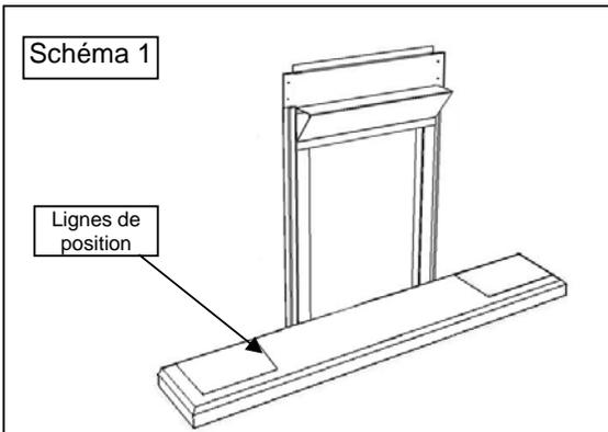
Pour l'installation de la bordure de foyer, consultez les instructions fournies avec la bordure. Placez la base de foyer fermement en position en la fixant avec du mastic. Ne mélangez qu'un tiers du mastic à la fois. Assurez-vous que la base est centrée et à niveau avec l'appareil. Pour vous faciliter la tâche, la base a été marquée (lignes) pour indiquer la position des pattes. **Faites un essai de la bordure.**
