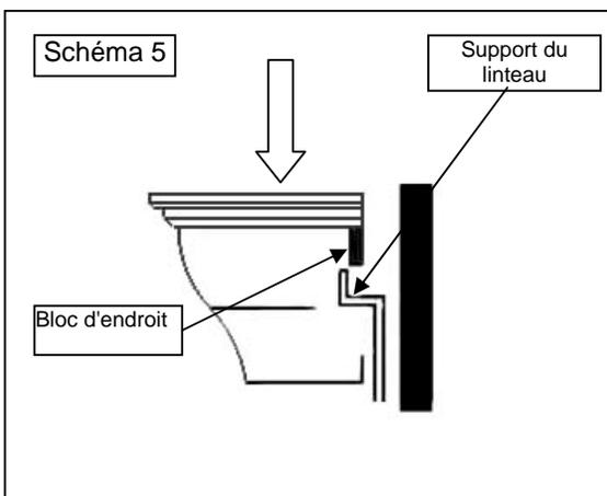
Étendez une mince couche de mastic sur le mur et sur le dessus des pattes. Abaissez le linteau soigneusement en positionnant le bloc de soutien sur le support du linteau. Alignez les joints et revisez l'alignement d'ensemble en faisant attention aux coins et aux rebords.
