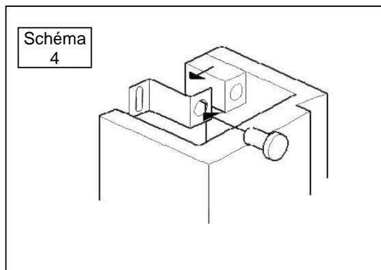
Étendez une mince couche de mastic sur le mur et la base de foyer à l'intérieur de la marque au crayon. Placez soigneusement la patte et fixez-la dans le mastic tout en l'alignant avec son support. Fixez la patte au support en insérant un goujon d'ancrage dans le bloc à l'intérieur de la patte. Répétez avec l'autre patte.
