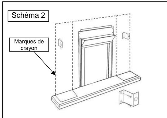
Placez les pattes sur la base en les alignant avec les lignes et la bordure du foyer. Alignez les blocs percés de l'intérieur des pattes et marquez le mur pour l'installation des supports. Soulevez le linteau avec soin et placez-le sur les pattes. Centrez et marquez au crayon le pourtour du manteau de cheminée pour en faciliter l'installation.
