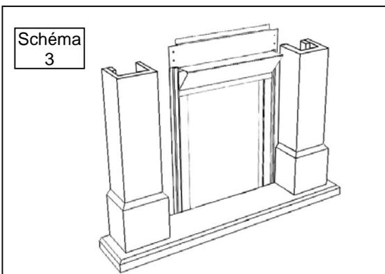
Retirez avec soin chaque morceau et les replacez sur une surface coussinée. Utilisez les fixations appropriées et chevillez le mur au centre du foyer. Fixez les supports avec les vis fournies.
