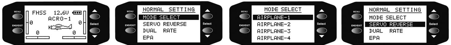
L'écran d'accueil montre la position graphique des 4 trims, la tension des accus (ou des piles), "ACRO-1" et le schéma de l'avion indiquent que c'est le modèle d'avion N°1 qui est en service. En mode hélicoptère "HELI-1" et le schéma d'un hélicoptère sont affichés.
