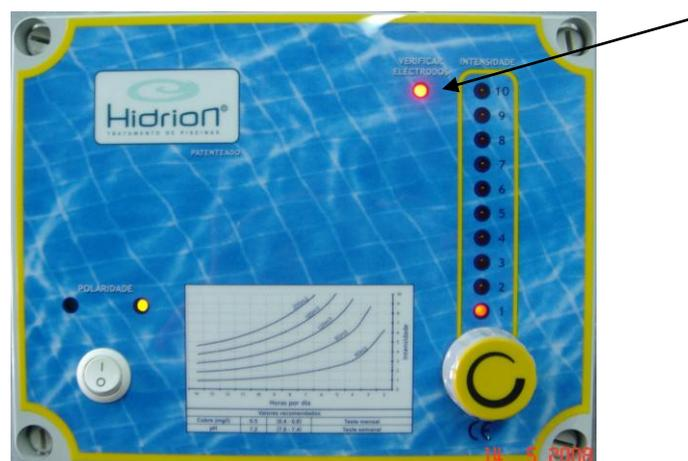
Signalisation Lumineuse du besoin de Vérification/Remplacement des Electrodes
