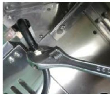
2. Installer le tuyau du régulateur de GN (Gaz naturel) au collecteur et fixer à l'aide d'une clé. Fixer le régulateur GN sur le panneau latéral à l'aide des deux vis 5/32\*10mm qui sont préassemblées au régulateur GN.
