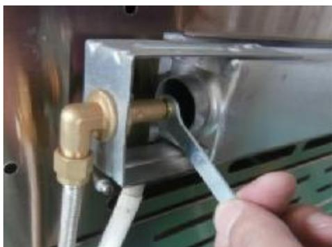
3. Remplacez l'orifice de gaz GN à l'aide d'une clé de 6 mm. Placez ensuite la chicane arrière et vissez dans sa position initiale.
