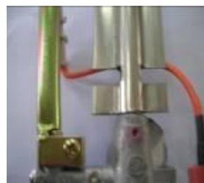
**Étape 2.** Fixez le brûleur principal à la paroi arrière de la chambre de cuisson avec 1 ergot puis fixez à l'avant de la chambre de cuisson avec 1 vis.
