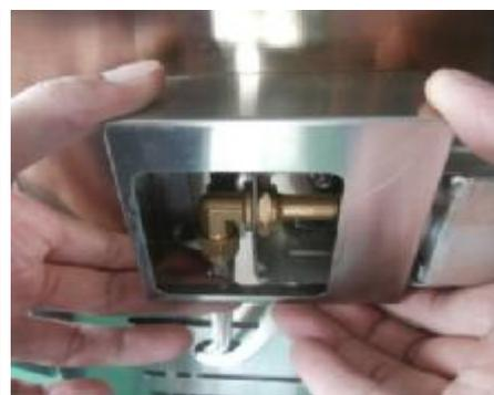
2. Enlevez l'orifice de gaz PL à l'aide d'une clé de 6 mm.
