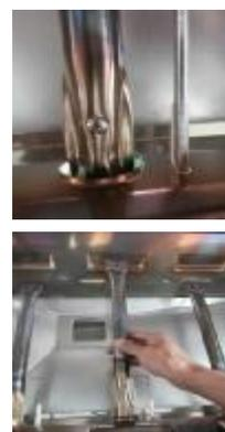
3. Enlevez l'orifice PL à l'aide d'un tourne-écrou de 6 mm de chaque brûleur principal et remplacez manuellement par un orifice GN (4 brûleurs principaux).
