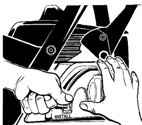
LEVIER DE TENSION EN POSITION D'INSTALLATION
