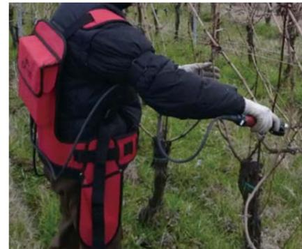
Le sécateur en lui-même, très léger, pesant seulement 830 grammes, permet de réaliser une coupe d'une grande précision. La qualité d'acier et de fabrication des lames, les différents traitements qui leur sont appliqués, et leur forme exclusive permettent d'utiliser le sécateur EP-700 pour les travaux de coupe les plus exigeants, et garantissent une coupe très aisée jusqu'à 30 mm.
