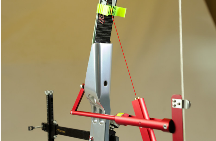
Fig 5 Vérification de l'alignement de la branche supérieure
