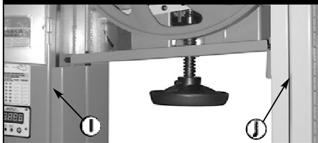
3. Ouvrez la porte du couvercle des roues inférieure et supérieure, puis tirez doucement la lame hors de la fente du côté gauche du bâti **e**, et hors du protecteur de lame **f**.
