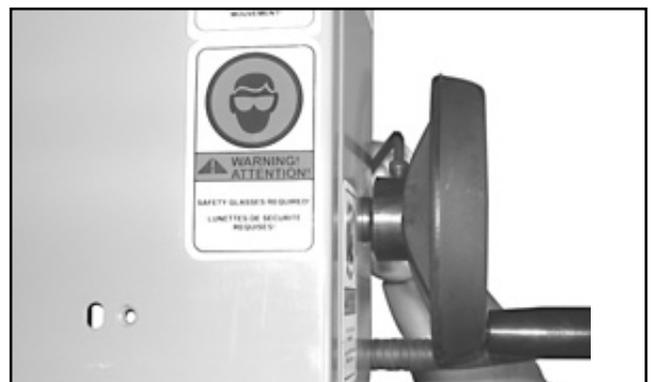
2. Serrez le boulon à l'aide de la clé Allen 5 mm fournie afin de verrouiller le volant de manoeuvre en place.
