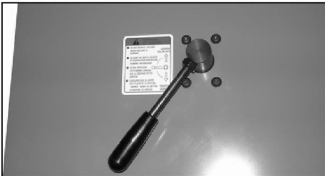
1. Placez le levier de tension dans la position "serrer" **a** pour un tensionnement rapide de la lame.
