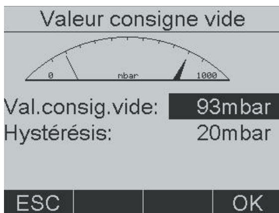
Fig. 6.5: Valeur de consigne de la pression sans la pompe à vide V-700/710
