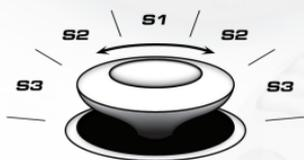
il s'agit des 3 secteurs du levier analogue sur le joystick, à partir du centre jusqu'à l'extrême bord extérieur. 1 correspond au premier tiers de la course du levier; 2 au second tiers et 3 le tiers final de la course du levier. En effectuant un réglage fin de ces paramètres, vous pouvez adapter la sensibilité du levier analogue à vos préférences personnelles.
