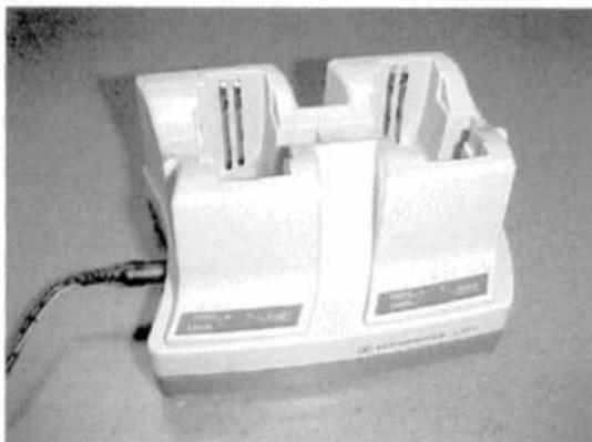
On doit charger le système MF à tous les soirs. Lorsque l'émetteur et le récepteur sont déposés dans le chargeur, la lumière « CHARGE » s'allume et le matin, c'est la lumière « READY » qui est allumée. Si celle-ci n'est pas allumée, c'est que les piles sont faibles et ne peuvent plus se charger complètement. On doit alors commander des piles neuves.
