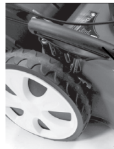
Levier de la hauteur de coupe. 8 positions: de 25 mm. a 75 mm.
