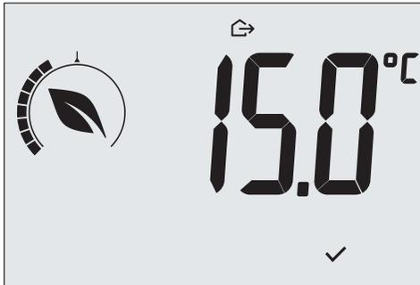
Fig. 8 : Accès au mode Absence avec indication de la température d'absence
