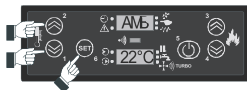
Réglage température de la pièce
