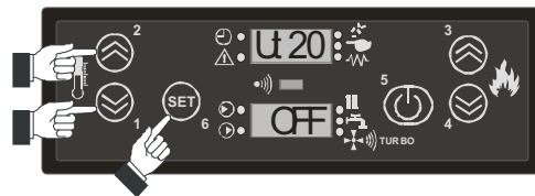
Activation du thermostat extérieur et conséquente désactivation du thermostat intérieur
