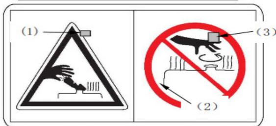
Cette étiquette indique que le réservoir est chaud et sous pression. Si vous ouvrez le couvercle du radiateur ou la boîte d'huile hydraulique, l'eau chaude ou l'huile pourraient sortir et vous provoquer des brûlures.
