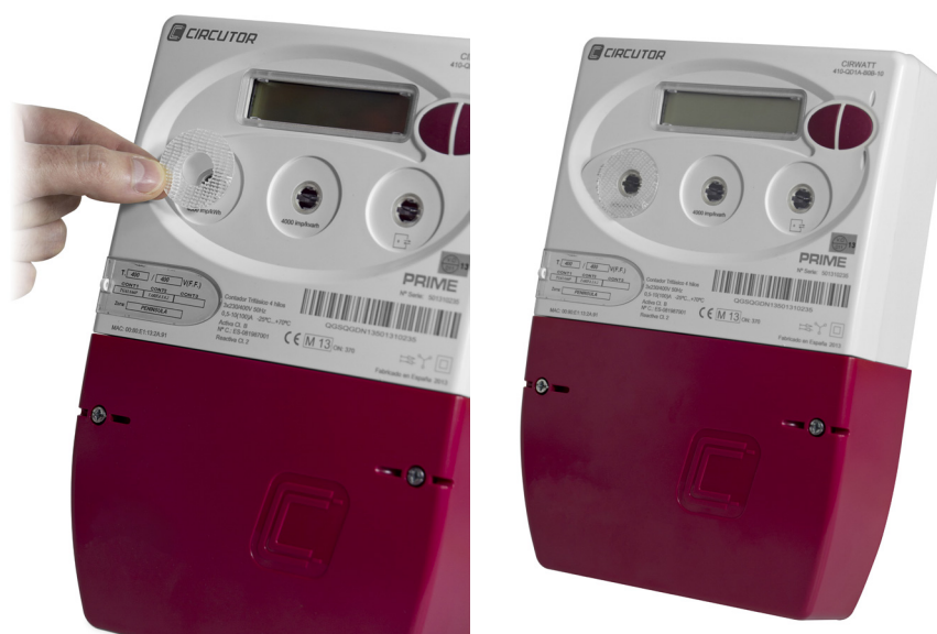
Figure 2: Coller une partie du velcro sur le port optique du compteur.
