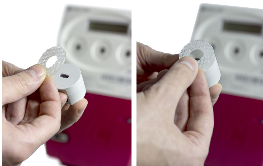
Figure 1: Coller une partie du velcro sur la partie arrière du READWATT.
