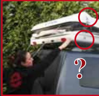
*Combien de défauts sur la Discovery Baroud: les bras de soulèvement gênent l'accès et sont dangereux. Il est en outre difficile de replier le tissu à l'intérieur des coques lorsque l'on ferme la tente.*
