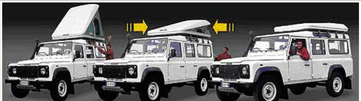
*La Columbus se ferme facilement et très rapidement car le tissu se replie à l'intérieur et se fixe à l'aide d'élastiques.*
