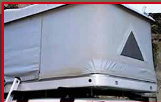
*Voici ce qui peut arriver sur une Baroud encore en garantie. Les propriétaires ont tenté de remédier aux lacérations et aux abrasions subies par le tissu, causées au cours du voyage par l'écrasement du tissu entre la base et le toit - il s'agit d'un défaut de conception- en collant simplement des morceaux de tissu et de papier adhésif sur la circonférence de la tente.*
