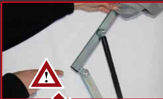
*Le système d'ouverture à ressort de la tente Baroud met en évidence les limites de son projet qu'il essaye de masquer par le biais d'un sac en tissu léger qui n'assure qu'une faible protection. Cela ne suffit pas à protéger des fuites d'huile provenant des ressorts hydrauliques.*
