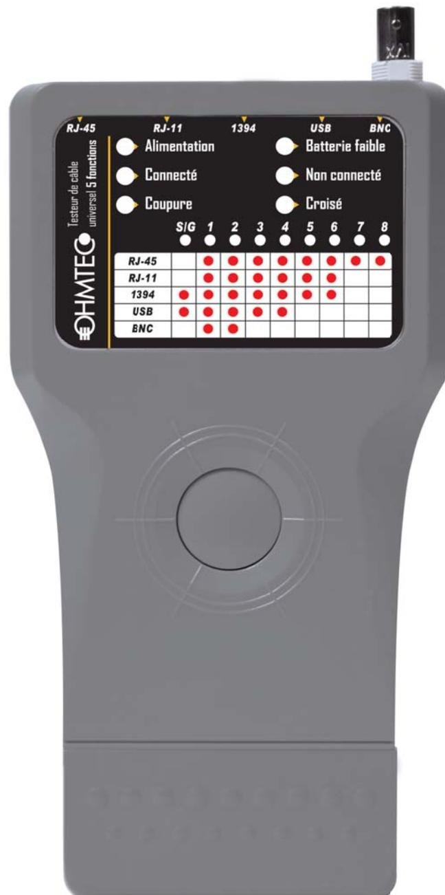
Cet appareil à l'ergonomie soignée vous permet de tester la continuité des câbles RJ11, RJ45, BNC, 1394 et USB. Son émetteur est à raccorder à l'extrémité du câble à tester. Une simple pression sur le bouton central du module principal vous donne immédiatement la continuité du câble testé. Permet des mesures sur des câbles de 305 mètres maximum.
