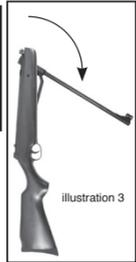
**CARABINES À AIR À CANON BASCULANT**—À l'aide d'une main, saisissez fermement la crosse à l'arrière du pontet en évitant tout contact avec la détente et appuyez l'extrémité de la crosse munie de la plaque de couche contre votre cuisse. Saisissez le canon près de la bouche, juste à l'arrière du guidon. Tirez vers le bas et l'arrière jusqu'à ce que le canon s'arrête. Vous entendrez un "clic" qui indique que le piston à ressort est bloqué en position (voir illustration 3).
