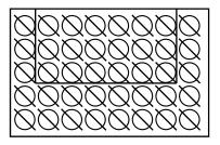
Positions des turbulateurs dans les générateurs 235 et 275 à échangeur de chaleur. Q.té : 40
