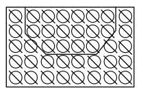
Positions des turbulateurs dans les générateurs 350 et 375 à échangeur de chaleur. Q.té : 28
