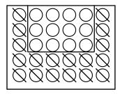
Positions des turbulateurs dans les générateurs 180 et 205 à échangeur de chaleur. Q.té : 40
