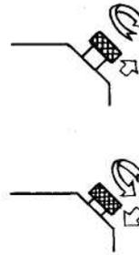
En tirant la pinule de coupe vers le haut et en la tournant vers la droite, on a une action rotative.
