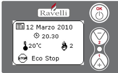
Dès que la phase d'extinction sera terminée, l'afficheur visualisera ECO STOP. Le poêle restera dans cet état jusqu'à ce que la température descende jusqu'à 15°C, seulement alors la phase d'allumage recommencera.
