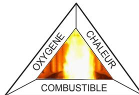
Le combustible et le comburante doivent être en proportions convenables pour que la combustion soit possible, délimitées du « champ d'inflammabilité ».
