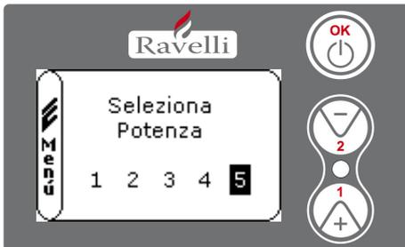
Pour modifier la puissance du travail, appuyer la touche 2 pour entrer dans le menu dédié et avec les touches 1 et 2 régler la puissance désirée de 1 à 5 et confirmer avec la touche OK. En augmentant la puissance, augmentera aussi la consommation des granulés de bois et la vitesse de la ventilation de l'échangeur. Il n'est pas possible de modifier le set de puissance dans la phase de MODULATION TRAVAIL.
