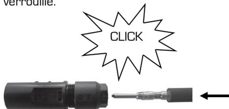
Serrez l'écrou de verrouillage sur le câble. Le couple initial de serrage est de  $1.3 + 0.2$  Nm; L'utilisation d'une clé dynamométrique à fente est recommandée (taille de la clé 13 mm, PN 523229-1).
