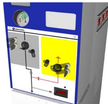
Figure 6.2 : Détail du verrouillage par clé sur une cellule CGM.3-L
