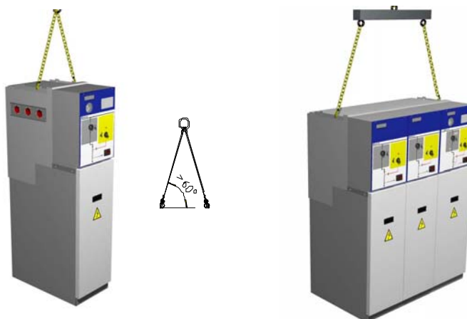
Figure 2.2 : Levage d'une cellule modulaire CGM.3 à l'aide d'élingues
