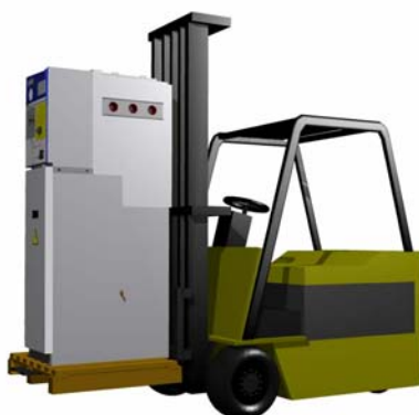
Figure 2.1 : Levage d'une cellule modulaire CGM.3 à l'aide d'un chariot élévateur
