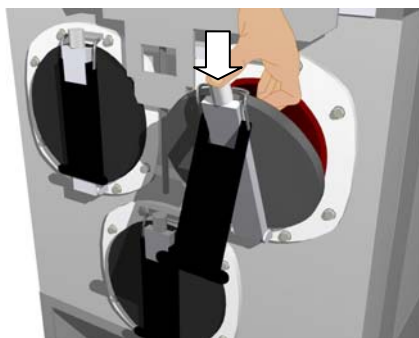
Figure 5.30 : Réarmement du percuteur du capot du tube porte-fusibles
