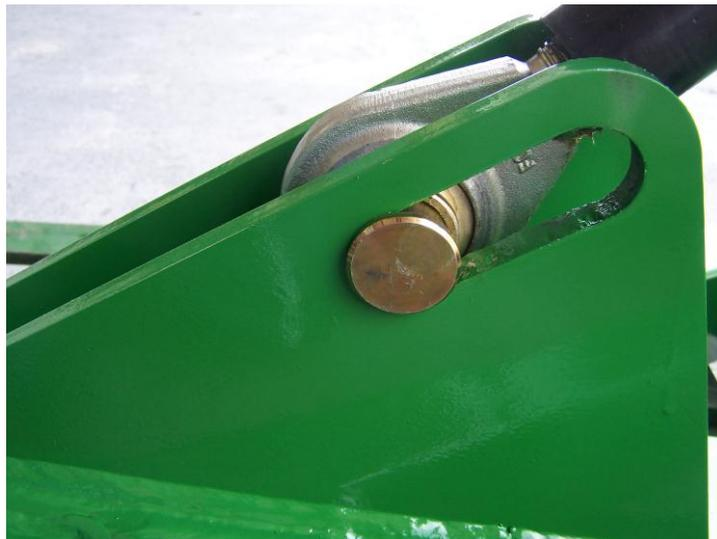
Au travail l'axe doit être dans cette position, dans le cas contraire agir sur le 3<sup>ème</sup> point pour arriver dans cette position.
