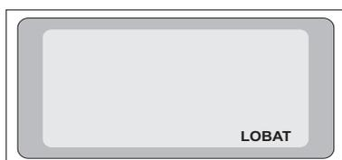
De plus, l'indication "**LO BAT**" apparaîtra dans la partie inférieure droite lorsque les piles sont faibles (<10%). Dans ce cas, remplacer les 4 piles.
