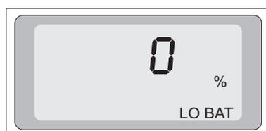
Lorsque les piles sont trop faibles pour effectuer les mesures, le message 0% LO BAT apparaît pendant quelques secondes et l'appareil s'éteint automatiquement. Dans ce cas, les piles doivent être remplacées.
