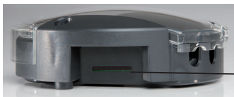
Vista laterale: slot scheda SD
