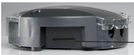
Vista lateral: Ranura para tarjeta SD
