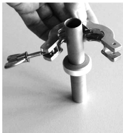
Montage de la bride de fixation
