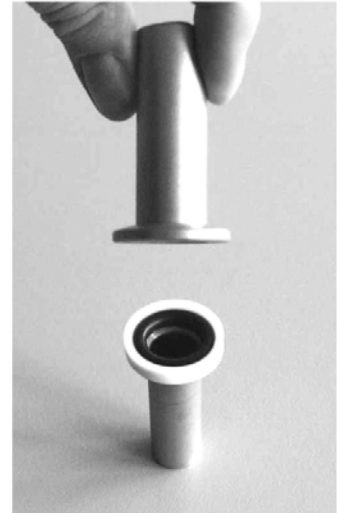
Petite bride avec bague de centrage placée et petite bride
