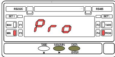
La fig. 19.1 présente l'affichage correspondant au niveau de l'accès au menu de configuration de l'affichage (leds F3 et PROG activées). Appuyer sur **ENTER** pour accéder à ce menu.
