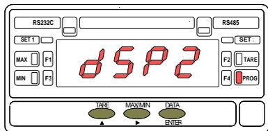
L'indication "dSP2" de la fig. 20.3 est présente pendant 2 secondes avant de passer au pas de programmation de la valeur de l'affichage pour le point 2 (DSP2)
