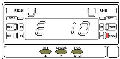
L'excitation antérieurement programmée est indiquée dès l'entrée dans ce pas de programme (ici E 10 pour excitation 10V). Si on désire changer ce paramètre, par **▶** on passe successivement de l'une à l'autre des deux excitations [**E 10** = excitation 10V ou **E 5** = excitation 5V].
