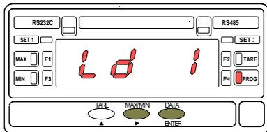
L'indication "Ld 1" dure 2s avant de l'entrée dans le pas de l'optimisation de la résolution du dernier digit. Ce réglage permet de choisir la variation du digit de poids faible en sauts de 1, 5 ou 10 points d'affichage.
