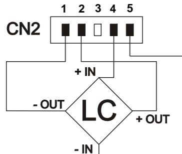
Schéma de raccordement du signal d'entrée pour 2 cellules de charge ou plus. Les cellules devront être raccordées en parallèle et alimentées par une source stabilisée extérieure.
