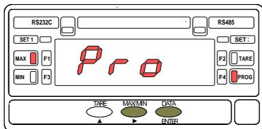
La fig. 13.1 présente l'affichage correspondant au niveau de l'accès au menu de configuration de l'affichage (leds F1 et PROG activées). Appuyer sur **ENTER** pour accéder à ce menu.
