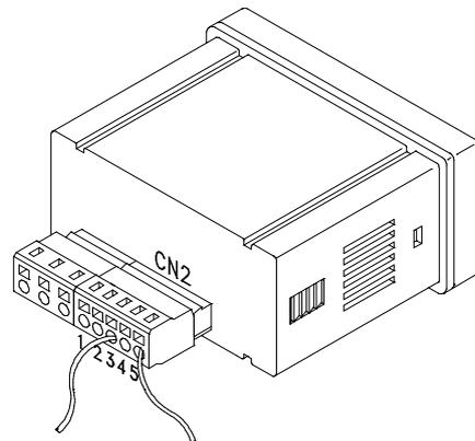
Schéma de raccordement de la signal d'entrée par cellule de charge avec plage d'entrée de 0-300 mV.
