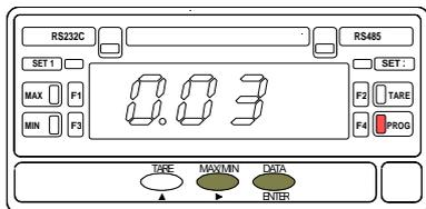
Le type d'entrée programmé antérieurement est donné par la fig. 13.2 (par exemple ici 0.03 plage d'entrée 30 mV). Si on désire changer ce paramètre, par **▶** on passe successivement de l'un à l'autre plage d'entrée [**0.03** = plage d'entrée 30 mV ou **0.3** = plage d'entrée 300 mV].
