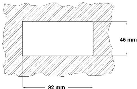
Faire avancer ces guides vers l'arrière du tableau de manière à ce qu'ils compressent le joint d'étanchéité et maintiennent l'appareil correctement en place. Pour démonter, soulever légèrement la languette arrière des clips et retirer chaque clip par l'arrière du boîtier.
