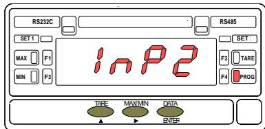
L'indication "INP2" de la fig. 20.2 est présente pendant 2 secondes avant de passer au pas de programmation de la valeur du signal d'entrée du point 2 (INP2).
