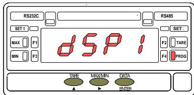
L'indication "dSP1" de la fig. 20.1 est présente pendant 2 secondes avant le passage au pas de programmation de la valeur d'affichage pour le point 1 (DSP1).
