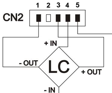
Schéma de raccordement de la signal d'entrée par cellule de charge avec plage d'entrée de 0-30 mV.
