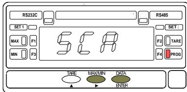
La fig. 19.2 présente l'affichage correspondant à la méthode de configuration de l'échelle d'affichage. Si on désire modifier ce paramètre, par impulsions successives sur **▶** aller à la méthode désirée [**SCA** = méthode de configuration par clavier ou **InP** = méthode de configuration par acquisition directe de la valeur réelle du signal d'entrée]. Appuyer sur **ENTER** pour valider la sélection et accéder au pas de programmation suivant.
