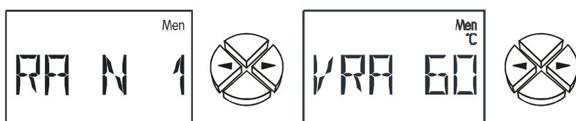
**RA N 1** Régulation de la valeur absolue en mode normal avec stabilisation de la sonde S1. Mode normal N signifie que la vitesse augmente au fur et à mesure que la température s'élève. Ce mode est valable pour toutes les applications servant à la stabilisation de la « sonde de départ » (collecteur, chaudière...).
