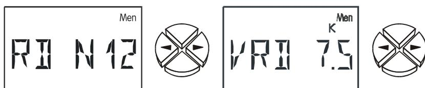
**RD N12** Régulation de la **différence** en mode **normal** entre les sondes S1 et S2. (RU = --)
