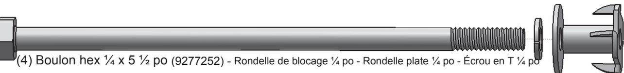
(4) Boulon hex ¼ x 5 ½ po (9277252) - Rondelle de blocage ¼ po - Rondelle plate ¼ po - Écrou en T ¼ po
