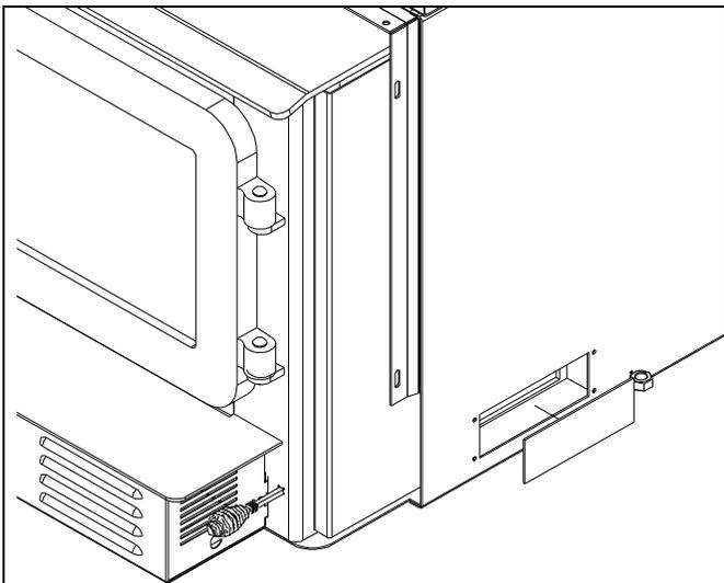
1- À l'aide de pinces, retirez le rectangle intérieur retenu par les microjoints afin de dégager l'ouverture prévue pour la prise d'air extérieur.
