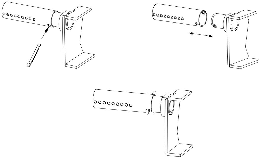
**Figure 4.3 – Remplacement des tubes d'aération auxiliaires**
