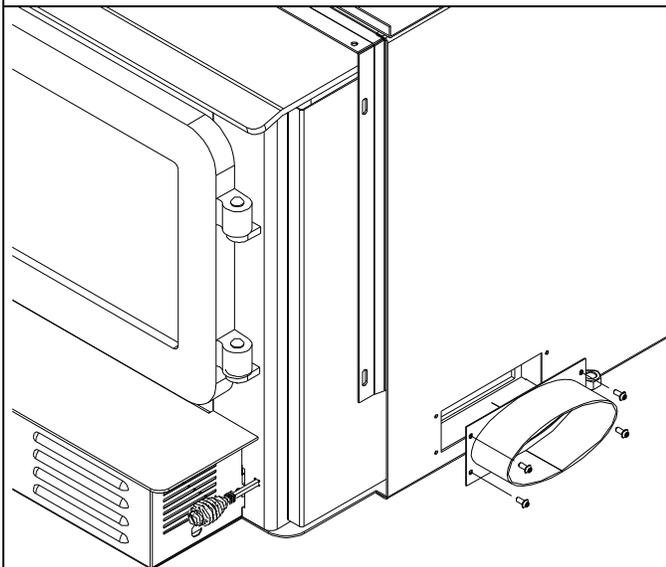
2- Installez l'adaptateur de prise d'air extérieur à l'aide de 4 vis.
