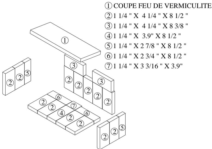
**Figure 4.2 – Disposition des briques pour le modèle XTD1.5-I**
