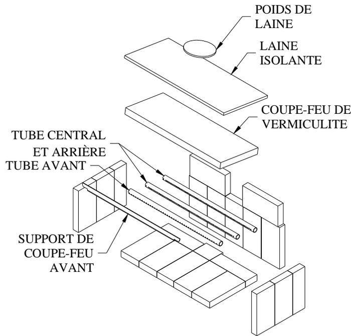
**Figure 4.1 – Installation du déflecteur pour le modèle XTD1.5-I**
