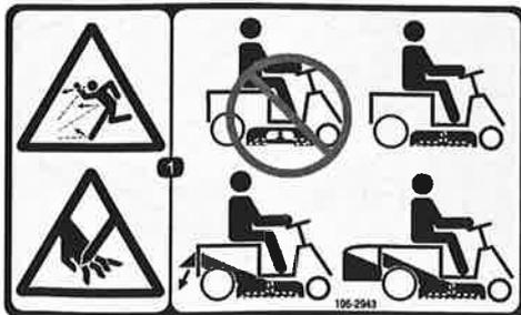
Risque de projections et de coupure/mutilation — n'utilisez pas la machine avec l'éjecteur ouvert ; utilisez toujours la machine avec l'obturateur de recyclage, le déflecteur d'éjection arrière ou le bac à herbe en place.
