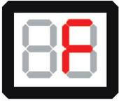
Le cadre d'affichage du compresseur "indicateur de dysfonctionnement" peut indiquer avec ce symbole un compresseur défectueux.
