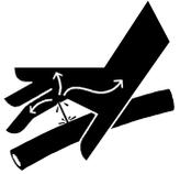
Fluides hydrauliques sous pression. N'utilisez AUCUNE des parties de votre corps pour localiser une fuite hydraulique. Les fuites de fluides sous pression peuvent entraîner des blessures graves, voire même mortelles. En cas de blessures dues à une fuite de fluide hydraulique, consultez immédiatement un médecin afin d'éviter des blessures corporelles graves.
