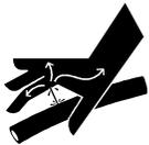
Fluido hidráulico bajo presión. NO exponga ninguna parte de su cuerpo para detectar alguna pérdida de líquido hidráulico. Los escapes de fluidos bajo presión pueden causar lesiones graves o la muerte. Si se producen lesiones por escapes de fluido hidráulico, consulte de inmediato con un médico para evitar lesiones corporales severas.
