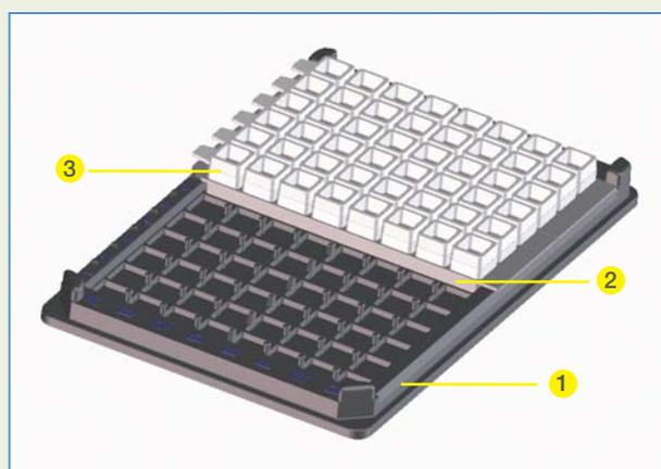
Figure 3: Structure de la HTA™Plate: (1) cadre, (2) module de 24 puits, (3) collerette de lavage pour 24 puits
