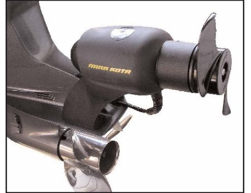
Dans le cas d'un seul moteur EM MinnKota, montez-le sur la plaque anticavitation du moteur principal, dans le cas de deux moteurs EM MinnKota, montez-les sur le support de montage inférieur lequel se monte sur la plaque anticavitation du moteur principal. Placez le moteur EM MinnKota aussi près que possible du moteur principal. Dans quelques cas, le support de montage peut avoir à être « fléchi » dans un sens ou l'autre pour assurer un bon ajustement sur la plaque anticavitation.
