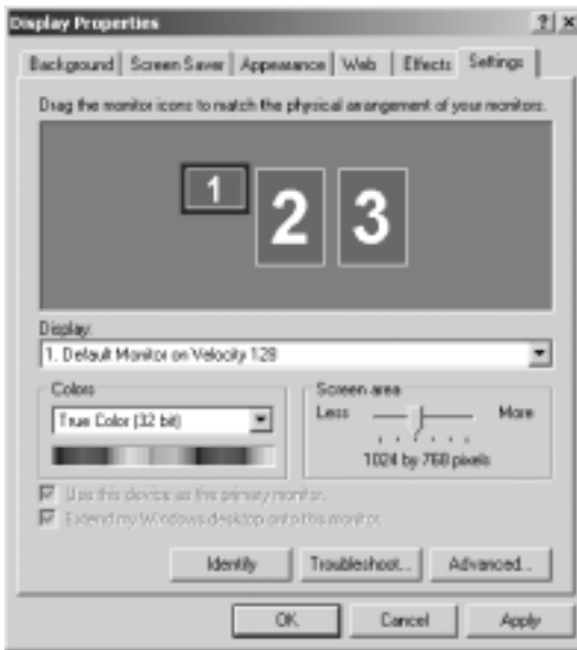
Figure 20 : BarcoMed Nio-DualView activé, les moniteurs 2 et 3 représentent les deux écrans connectés à une même carte BarcoMed Nio.
