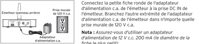
**Nota : L'émetteur ne comporte aucun interrupteur de MARCHE / ARRÊT. L'émetteur est conçu pour être le branché et alimenté en tout temps. Si vous prévoyez de ne pas utiliser le AWS63 pendant une période de temps prolongée, débranchez l'adaptateur d'alimentation c.a. de l'émetteur.**
