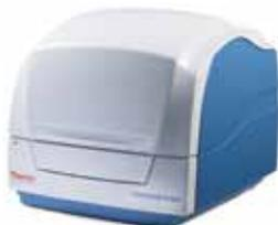
Le lecteur multimode Thermo Scientific Varioskan Flash permet d'exécuter aisément un large éventail d'applications avec un degré de sensibilité élevé, des applications à point final aux applications cinétiques exigeantes pour une fiabilité supérieure.
