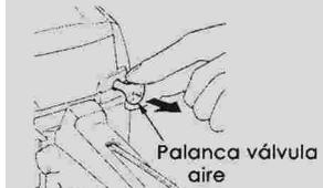
*Nota: Cuando se reencienda el motor inmediatamente después de la parada, es necesario colocar la palanca válvula aire en la primera posición (válvula aire abierta y palanca acelerador en posición arranque)*
