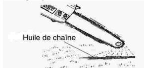
Pour régler le débit d'huile de chaîne, introduire un tournevis dans l'orifice située au fond du côté de l'embrayage.
