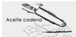
El caudal de aceite para cadena puede ajustarse insertando un destornillador en el agujero del lado del embrague. Ajústelo según las condiciones del trabajo.
