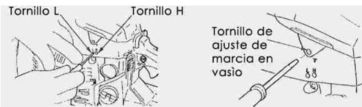
El carburador de su motosierra ha sido ajustado directamente en fábrica, pero puede ser necesario efectuar sucesivamente una regulación fina cuando se realiza una modificación en el modo de funcionamiento. Antes de regular el carburador, asegúrese que los filtros aire/combustible estén limpios y que el combustible este mezclado correctamente.
