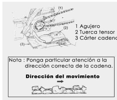
4. Ensamble el cárter cadena al cuerpo del motor y apriete las tuercas con la fuerza de la mano.
