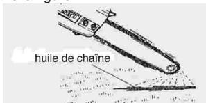
Pour régler le débit d'huile de chaîne, introduire un tournevis dans l'orifice situé au fond du côté de l'embrayage.
