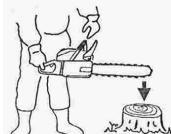
Si el freno no funciona correctamente, diríjase a su distribuidor para su control o reparación. Si se deja girar el motor a alta velocidad con el freno integrado, la fricción se sobrecalienta y esto podría dañar la herramienta.
