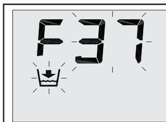
**N.B. :** Si la pression hydraulique descend en-dessous du seuil minimum de fonctionnement, l'afficheur indique l'anomalie **F37** clignotante avec le symbole (7). Une fois rétablie la pression hydraulique nominale, l'anomalie s'efface automatiquement.
