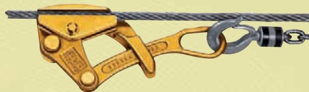
Avant chaque opération de mise en tension du câble : s'assurer que le câble électrique est solidement attaché entre les mâchoires de la pince.
