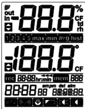
Toutes les sections s'affichent – les piles doivent être retirées puis réinsérées pour redémarrer la station de température.
