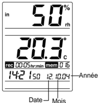
La date par défaut de la station de température est 1. 1. de l'année 2004. Dès que le signal radiocommandé est reçu, la date est mise à jour automatiquement. Si le signal n'est pas reçu cependant, la date peut également être programmée manuellement.
