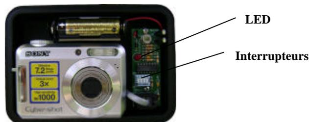
Ajustement des interrupteurs sur le circuit électronique.
