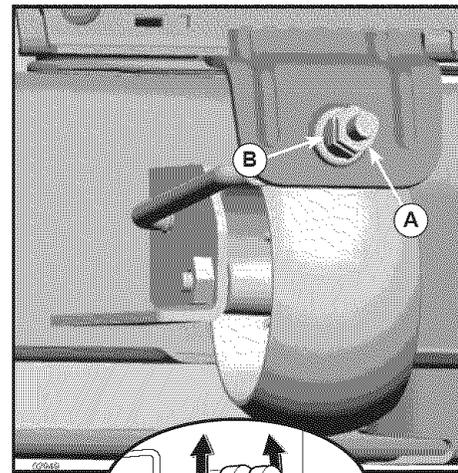
Serrez l'écrou d'ajustement B pour soulever la tondeuse.
