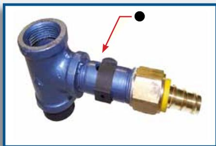
Le régulateur d'abrasif AR  $\frac{3}{4}$  se situe au bas du cabinet (Page 9, n° 11). Veillez à ce que rien n'en obstrue l'orifice. Réglez l'ouverture de l'orifice● qui doit toujours se situer au-dessus, à environ 1/3 ouvert, grâce à la pince ajustable. Une plus petite ouverture amènera plus d'abrasif au pistolet, une plus grande moins d'abrasif. Une ouverture une fermeture complète empêchera l'arrivée de l'abrasif.
