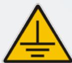
**Il est important de connecter le système Canablast à la mise à la terre pour décharger l'électricité statique, qui peut être générée lors du sablage. La mise à la terre peut aussi réduire l'inconfort auquel un opérateur peut être confronté lorsque l'électricité statique est générée.**
