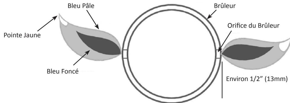
**Brûleur Tube:** Le brûleur est fait d'acier inoxydable 304, mais en raison de la chaleur extrême et d'un environnement corrosif, il se produira une corrosion de surface. Enlevez cette corrosion à l'aide d'une brosse en laiton. Nettoyez les orifices bouchés à l'aide d'un trombone déplié. N'agrandissez surtout pas les orifices du brûleur.
