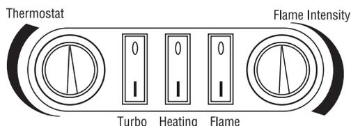
**EFFET DE FLAMME (FLAME) :** Mettez ce bouton en position « I » pour mettre l'alimentation principale en circuit et obtenir l'effet de flamme. Le témoin indicateur correspondant s'allume. Voir les autres interrupteurs de commande ci-dessous.
